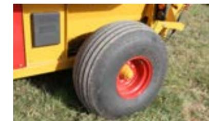
Große Niederdruckreifen sorgen für einfachen Transport und eine stabile Basis für die H-1030.
