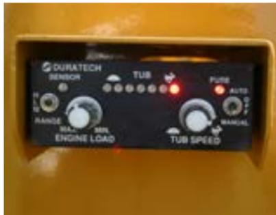
Ein kontinuierlicher Betrieb der Maschine wird durch den elektronischen DuraTech Drehzahlregler garantiert. Dabei sorgt der Regler dafür, dass der Traktor gleichmäßig beladen wird. Der Leistungsbedarf der Maschine kann durch Einstellen der Trommeldrehzahl, somit der Materialzufuhr, zum Mahlwerk geregelt werden.
