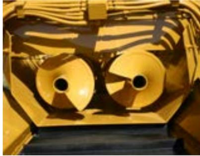
Die zwei 30,48cm Förderschnecken sind auf zwei stabilen Lagern an der Basis des Siebbereiches platziert. Dieses System erlaubt einen abgedichteten Auswurfbereich. Die Weite des Auswurfbereichs ermöglicht außerdem einen hohen Durchsatz und geringes Verstopfungsrisiko.
