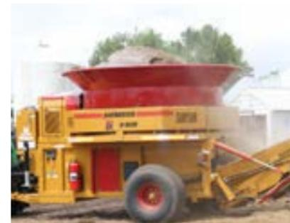
Die H-1030 hat eine leistungsstarke, 3,13m breite Trommel. Diese Trommel ist 1,13m tief und kann jegliche Art von Ballen verarbeiten.
