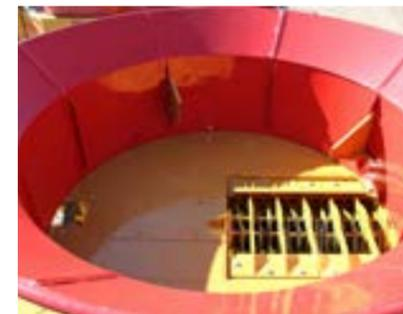
Die H-1000 Trommel ist 3,13m breit und 1,13m tief und besteht aus einem 3,42mm starken Stahlboden und 1,89mm starken Stahlseitenwänden. Die H-1000 Trommel hat die Kapazität, jegliche Art von Ballen zu verarbeiten.
