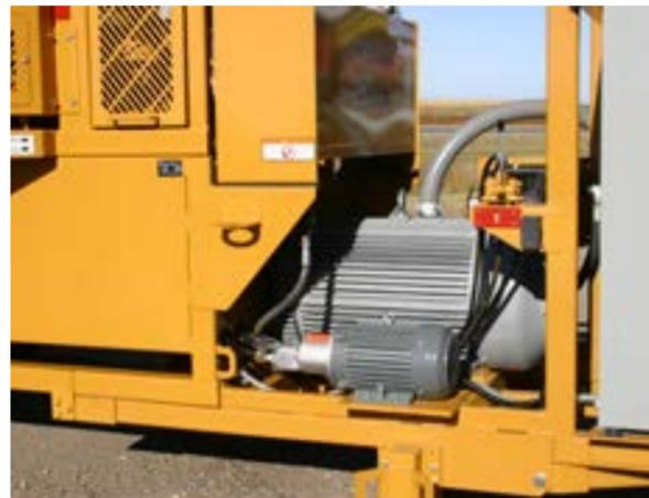
Ein Soft-Startpaneel sorgt für einen „sanften“ Start des 300 PS (23,8 KW) Hauptantriebs. Der 10 PS (7,46 KW) Motor für die Hydraulik wird mit einer direkten Leitung gestartet. Elektromotoren sind verfügbar als 460 Volt – 60 Hz, 380 Volt – 50 Hz, 380 Volt – 60 Hz und 575 Volt – 60 Hz. Jeder davon benötigt Drehstromleistung. Bitte überprüfen Sie vor der Bestellung Ihre Stromanforderungen.
