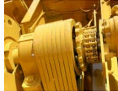
Der Keilriemenantrieb für den Mühlenrotor ist mit einem 8-5 VP Keilriemen ausgestattet um die erhöhte Drehzahl und die erhöhte PS Anzahl handzuhaben. Der Riemenspanner sorgt für konstante Spannung während das Band sich dehnt.
