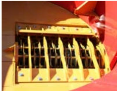
Die Hammermühle ist gebaut mit 4,76mm dicker Mühlenplatte mit 400mm Durchmesser auf denen 23,8mm gehärtete Hammerwellen 64 Hämmer mit einer Stärke von 9,52mm tragen. Diese Hämmer können Sie drehen und damit viele Stunden mahlen.
