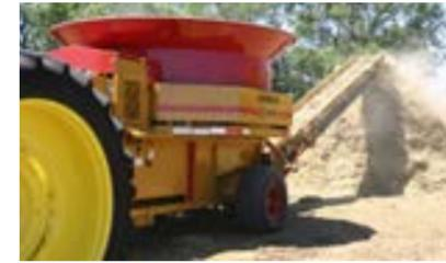
Die große H-1130 Big Bite Trommel besteht aus einem 3,42cm starken Stahlboden und einer 2,66cm starken Seitenwand. Der Durchmesser der Trommel beträgt 3,38m, die Tiefe 1,27m. Sie kann damit die größten Rund- und Quaderballen verarbeiten.
