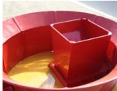
Hochleistungs-Getreidemahlen ist eine weitere, wichtige Funktion die die H-1000 ebenfalls ausführen kann. Durch Entfernen der Mahlgitter und dem Platzieren des optionalen Kornmahltrichters über der Hammermühlenöffnung, wird die H-1000 zu einer Hochleistungs-Getreidemühle.
