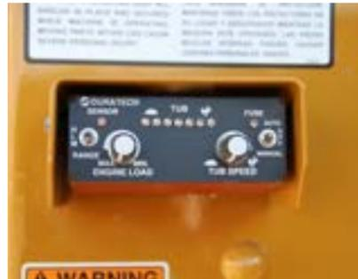
Die Rotation der Trommel wird durch einen elektronischen Regler gesteuert. Dadurch wird die Fördermenge stabilisiert, indem die Drehzahl der Trommel an die Motordrehzahl angepasst wird. Der Regler steuert ebenfalls die Trommelrichtung und Abbruch.
