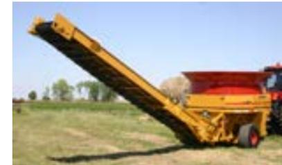
Das 7,92m lange und 61cm weite, faltbare, hydraulische Förderband ist ausgelegt für die erhöhte Kapazität der H-1130. Es ist fähig das Mahlgut bis zu 5,67m hoch zu stapeln.
