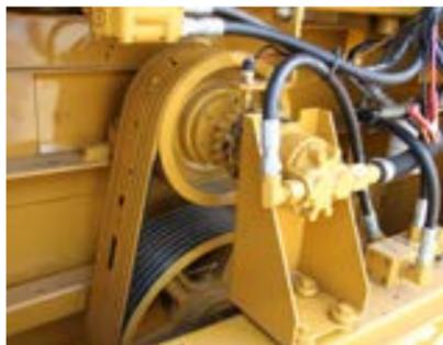
Das 8-Keilriemen-Bandsystem liefert ausreichend Kraft von der Zapfwelle zur Mühle. Das System hat eine feste Zugkraft um sich anzupassen. Damit wird die Mühle mit etwa 2x der Geschwindigkeit der Zapfwelle gedreht. Diese Mahlgeschwindigkeit sorgt für eine geschmeidige Zufuhr und liefert Mahlleistung mit hoher Kapazität.
