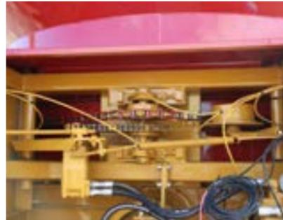
Die H-1000 Trommel wird von einem Hydraulikmotor angetrieben, welcher eine leistungsfähige Laufwalze betreibt. Das Kettenrad an der Trommel ist ein durchgehendes Kettenrad, welches eine formschlüssige und geschmeidige Übertragung von Kraft auf die Trommel bietet.
