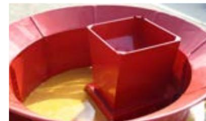
Leistungsstarkes Getreidemahlen kann mit der H-1130 ebenfalls gemacht werden Durch Platzieren des Kornmahltrichters auf der Hammermühle und Austausch der Siebe wird die H-1130 zu einer leistungsstarken Getreidemühle.
