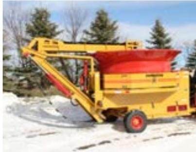
Das H-1000 Modell ist nun ausgestattet mit einem 45,7cm breiten und 6,1m langen hydraulischen Förderband. Das Förderband erlaubt es Ihnen Mahlgut bis zu 4,24m hoch zu stapeln.
