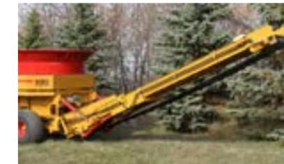
Das 6,4m lange und 61cm breite hydraulische Förderband ist ausgelegt für die erhöhte Kapazität der 3,05m Trommelmühle. Das Förderband kann über die Trommel gefaltet werden, für den einfachen Transport. Es ist fähig das Mahlgut bis zu 4,54m hoch zu stapeln.
