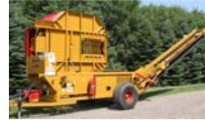
Die Trommel der H1030 kann ganze 90° geöffnet werden und bietet so einfachen Zugang zur Hammermühle und Innenmotor zur Instandhaltung.
