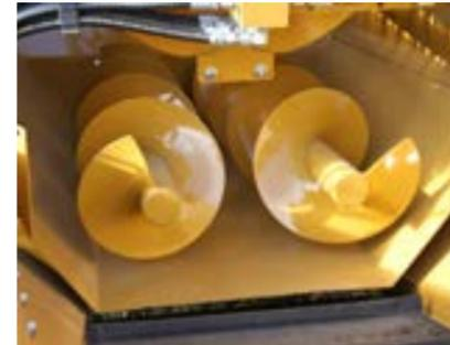
Die H-1030 hat zwei Förderschnecken mit einem Durchmesser von 30,48cm und einer Länge von 1,22m um das gemahlene Material zum Auswurfbereich zu bringen. Sie sind auf zwei stabilen Lagern an der Basis des Siebbereiches platziert, was einen reibungslosen Transport zum Förderband ermöglicht. Die Weite des Auswurfbereichs ermöglicht hohen Durchsatz
