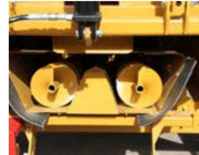
Die zwei 22,86cm großen Hochleistungsschnecken, welche an der Auffangwanne montiert sind, befördern das Produkt zum Förderband. Die Auffangwanne bietet eine saubere Umgebung um kleinere Produkte, wie zum Beispiel Gerste, aufzufangen und auszugeben.
