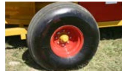
Große 16,5 x 16,1, 14-lagige Niederdruckreifen sorgen für einfachen Transport und eine stabile Basis für die H-1130.
