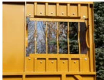
Die stabilen Rückhalter in den Sieben bieten die Möglichkeit die Anzahl der Rückhalter je nach Mahlbedingungen anzupassen. Es kann ein Blech montiert werden um das Herausschleudern von Steinen etc. aus der Trommel zu verhindern.
