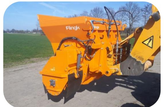
Der Behälter für den Sand und anderen Schmutz befindet sich an der Unterseite der Maschine. Durch Kippen der Maschine wird dieser geleert.
