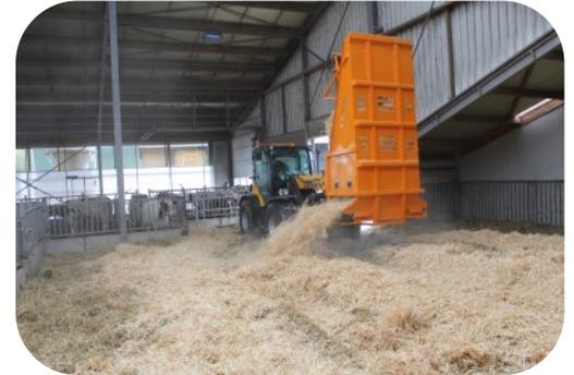
Mit dem für die minischaufel gebauten SVV 1000 kann ein dritter bis halber Ballen von 2500x1200x900 mm verteilt werden. Hier ein Bild mit 1800x700 Förderband, um links und rechts auf zu 2,5 bis 3 Meter zu Einstreuen.
